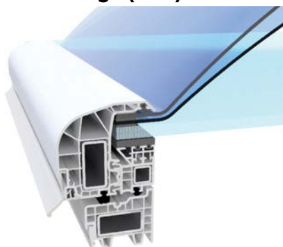
Rys. 54 Wypełnienie klapy - 2-warstwowa kopuła akrylowa i płyta z poliwęglanu komorowego
